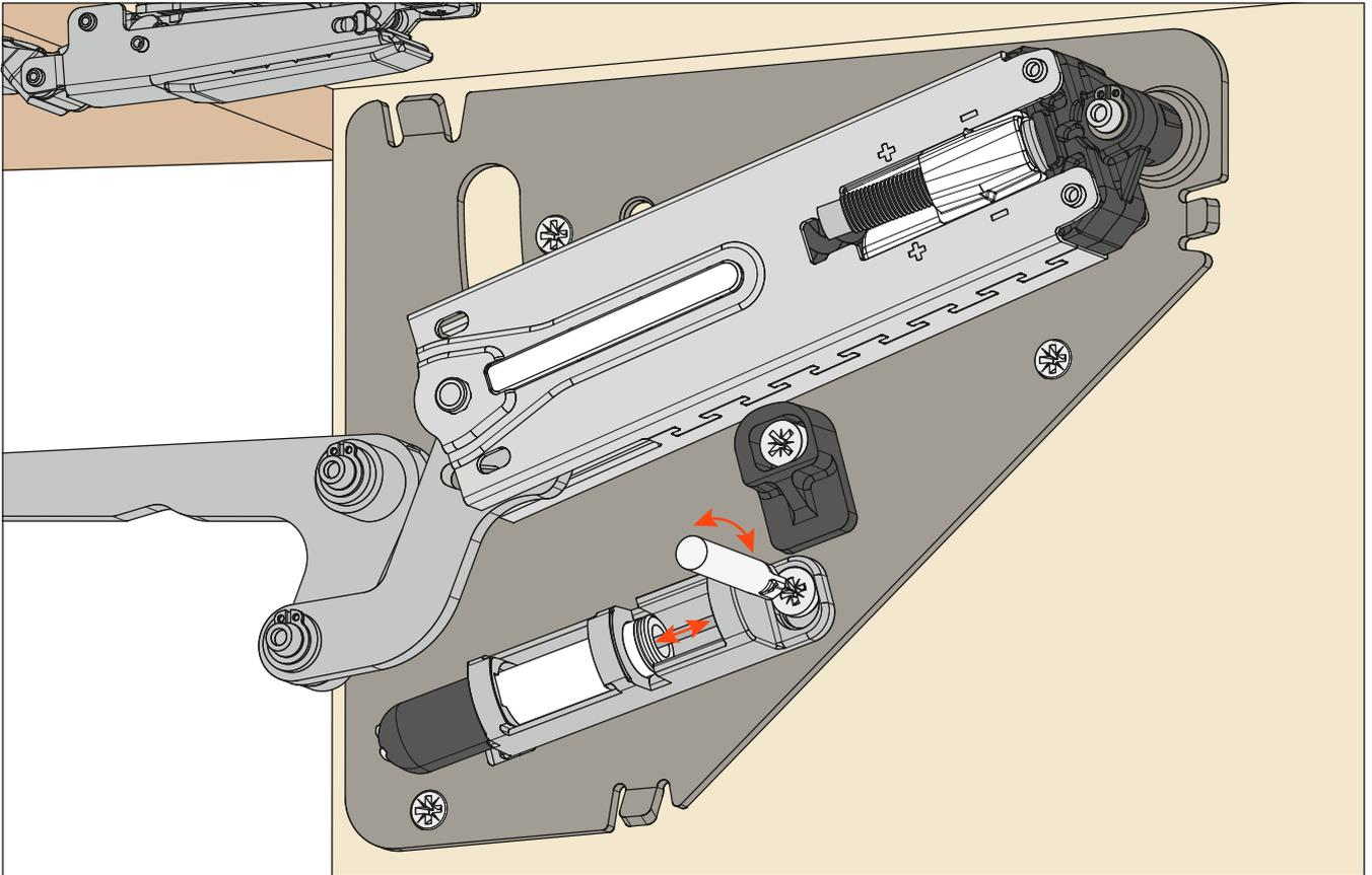
**Verstellung des Öffnungswinkels der Tür, mittels Exzenter, von 80° bis 92°.**
