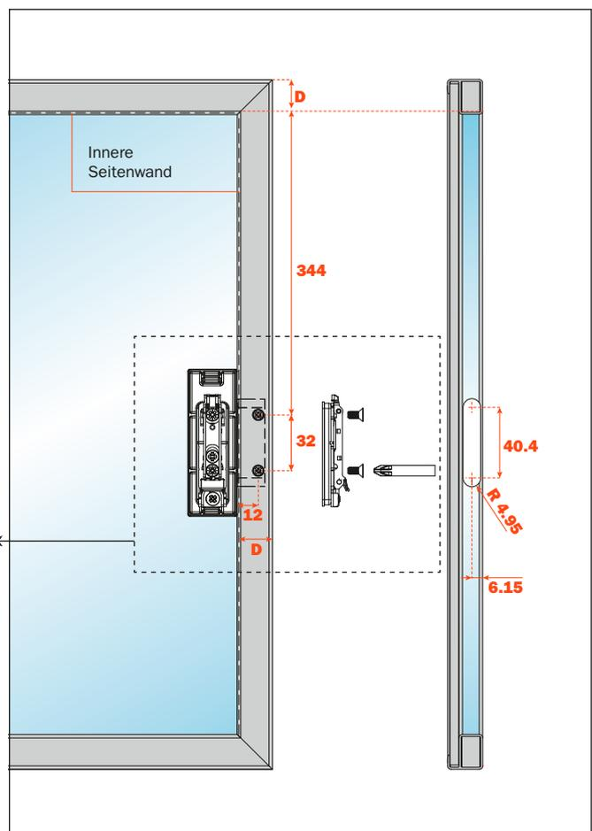
**EvoLift - Öffnungssysteme - Parallelliftbeschlag****Montageanleitungen****Befestigung des Systems an der Seitenwand.**
