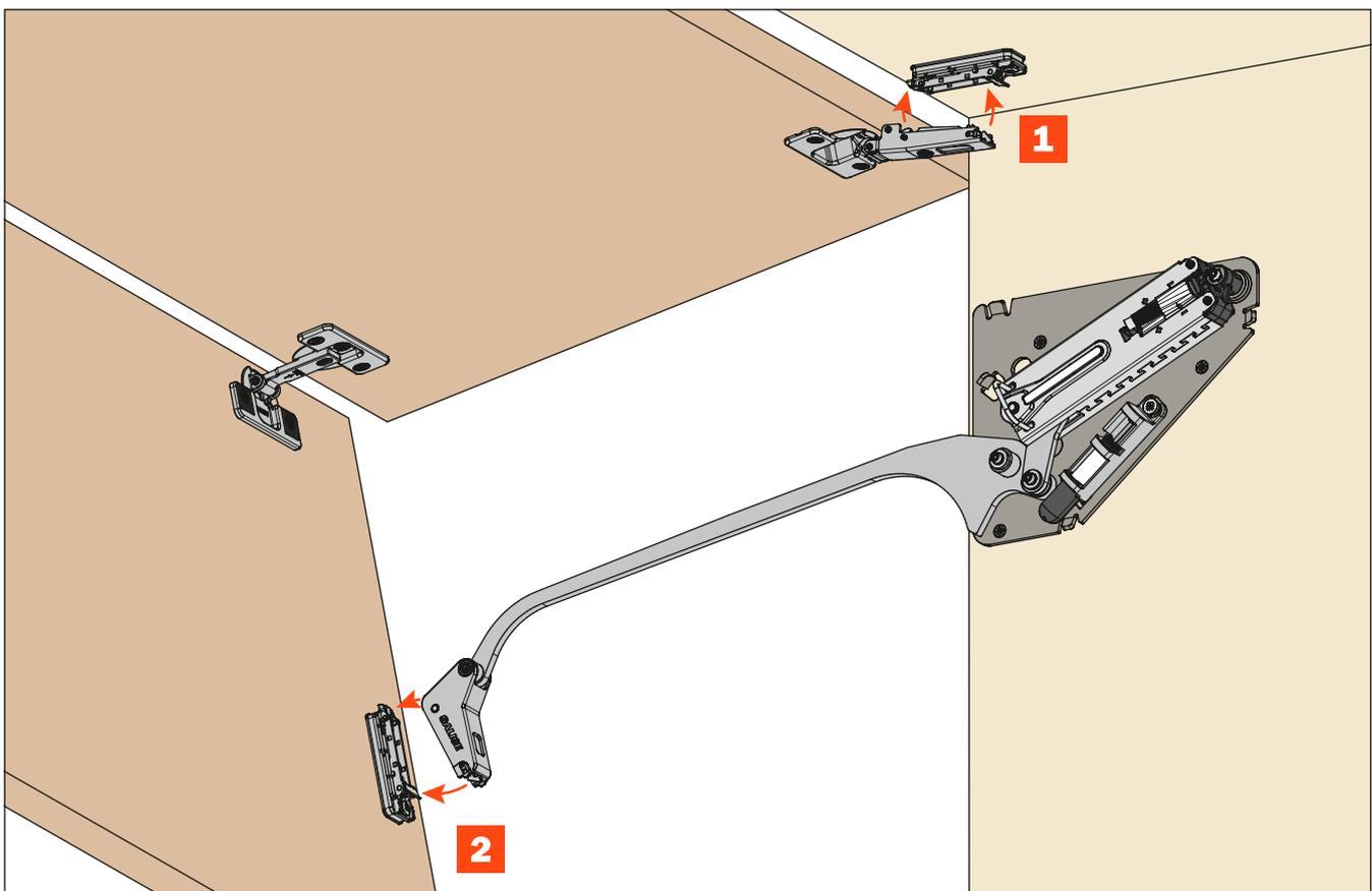
**EvoLift - Öffnungssysteme - Liftfalldtürbeschlag****Montageanleitungen****Herausziehen des Sicherungsbügels.**
