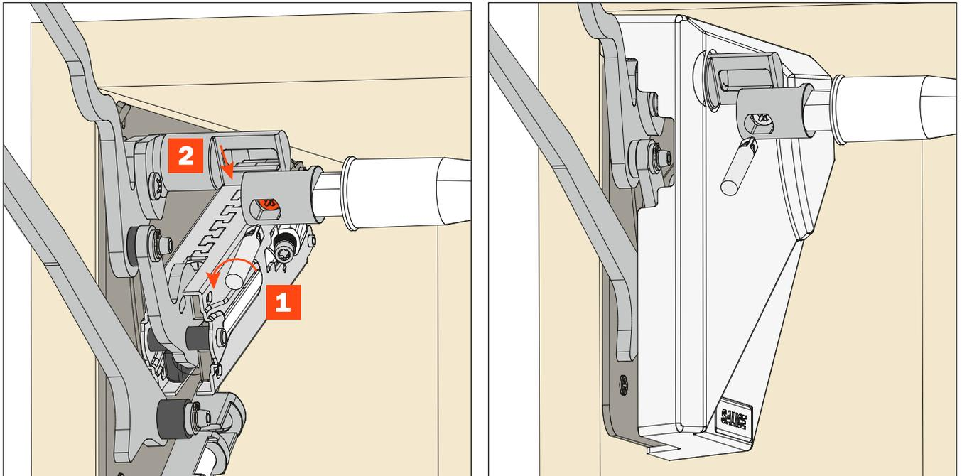
**Abmessung der Stabilisierungsstange = Innere Seitenwand - 126 mm**
