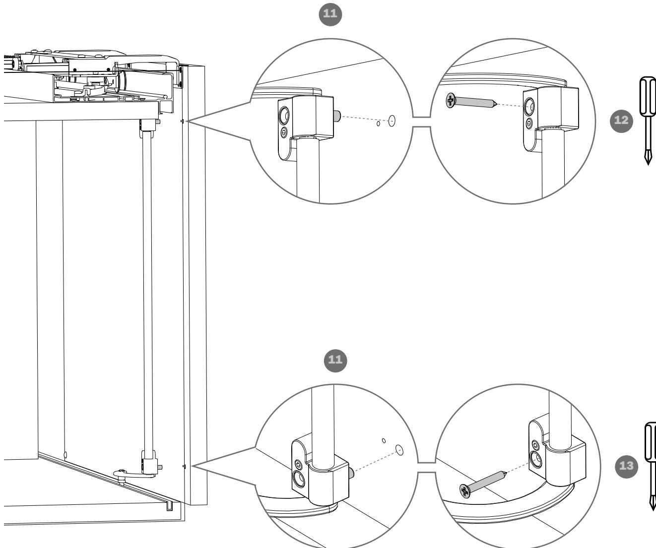
[ITA] MONTAGGIO DELL'ANTA DESTRA
