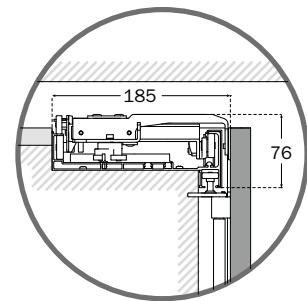
Spazio minimo per fissaggio e regolazione 35 mm.
